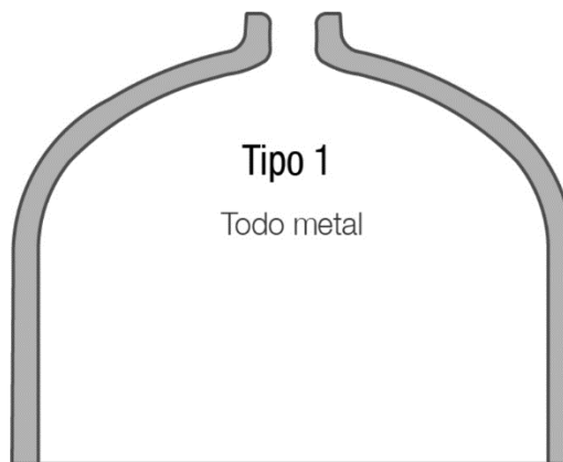
Figura 22: Tanque tipo I [20].
