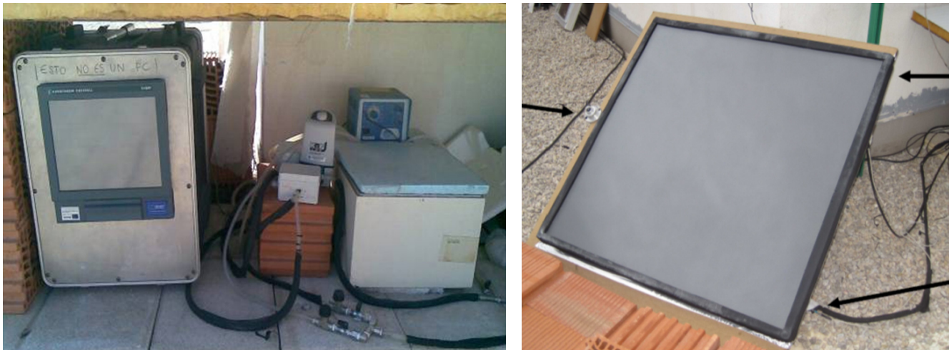
Figura 3. Dispositivo experimental utilizado y panel colector cerámico construido para el ensayo (ITC 2012).
