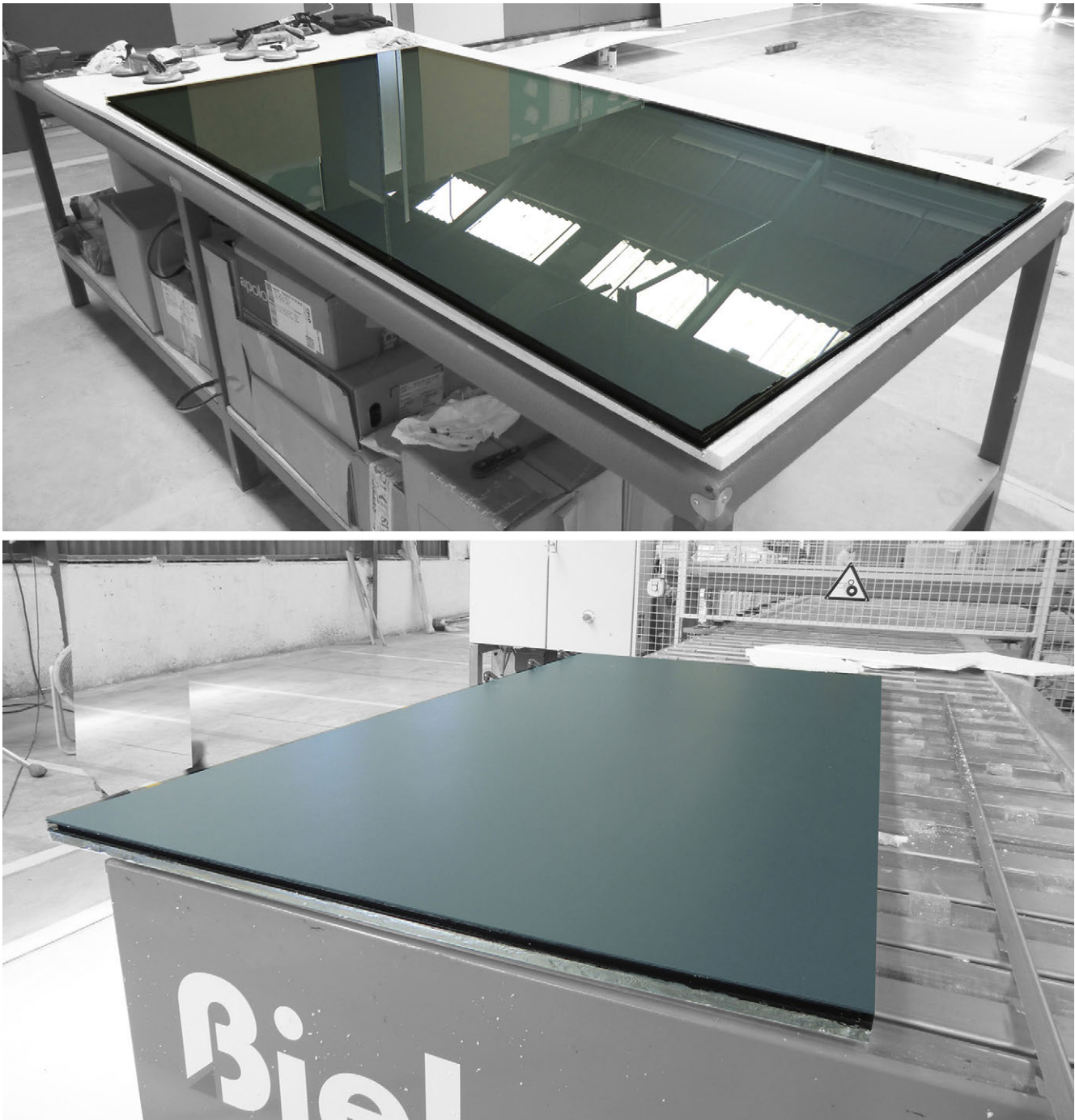
Figura 6. Prototipos de un panel cerámico colector (izquierda) y un panel cerámico no colector (derecha) (Roviras, J., 2012).
