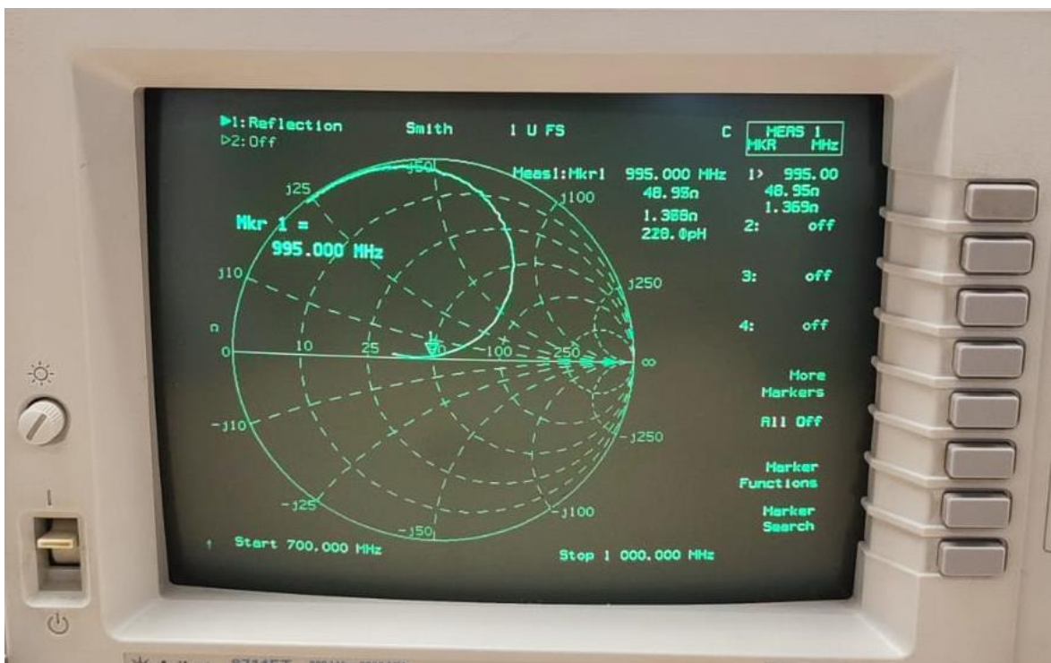
Figura 51: Adaptación circuito de tres etapas
